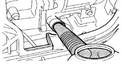
Снимите крышку маслозаливной горловины, как на рисунке.
